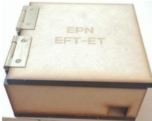
Figura 3.42 Caja del circuito de control de acceso
