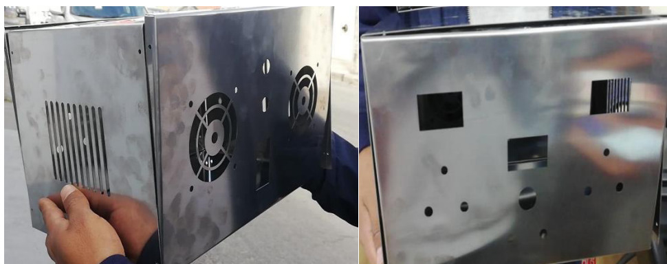
Figura 3.18 Doble de planchas de acero inoxidable.
