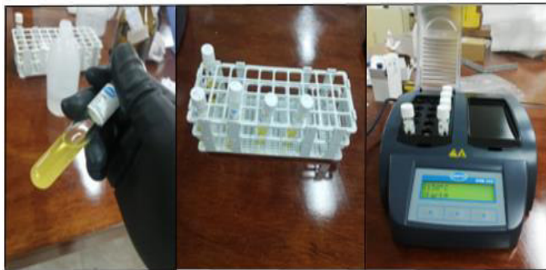
Figura 8: Digestión de viales de rango bajo para DQO
