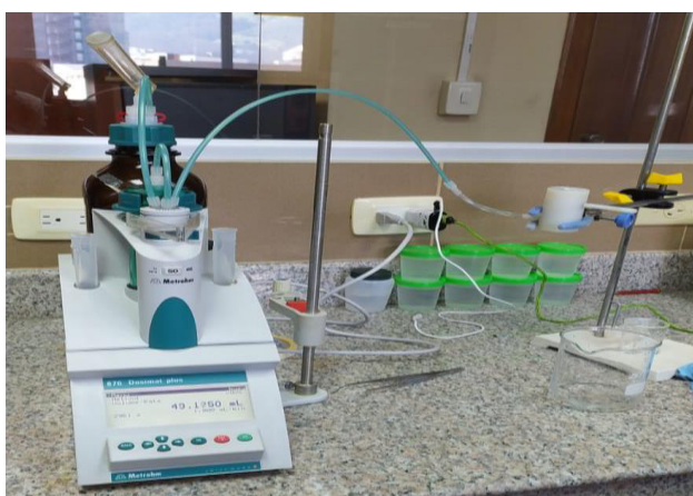
Fig. 3.18 Equipo dosificador conectado a celda de filtro (Fuente propia).
