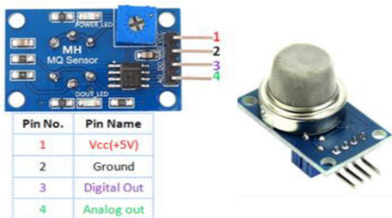
Figura 1.2 Pines del sensor MQ-6 [12]
