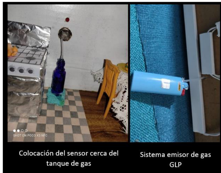
Figura 3.27 Sistema emisor de gas GLP
