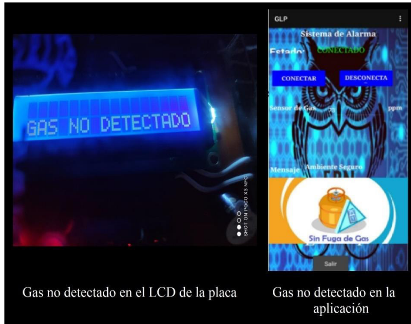
Figura 3.29 Gas no detectado en la placa y aplicación
