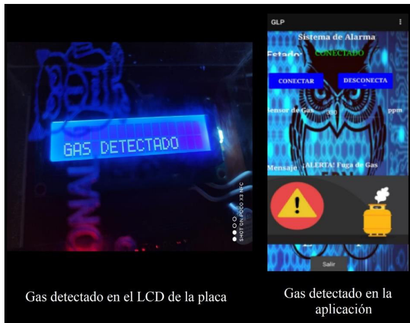
Figura 3.28 Gas detectado en la placa y aplicación
