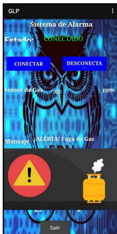
Figura 3.43 Aplicación detecta fuga de gas GLP
