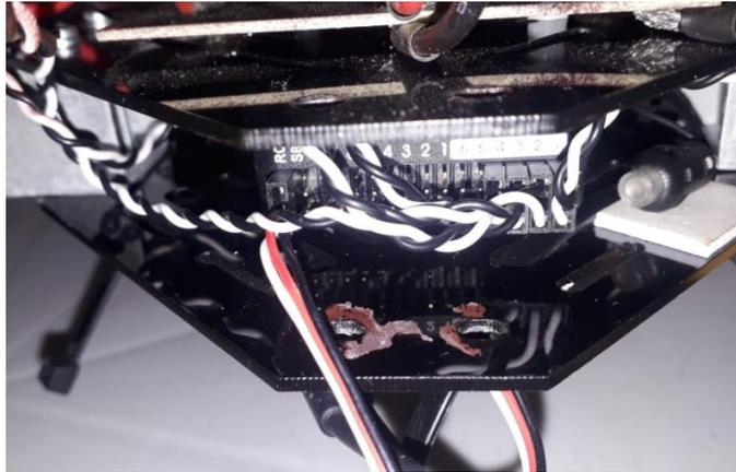
**Figura 3.37** Conexión de los ESC a la controladora de vuelo
