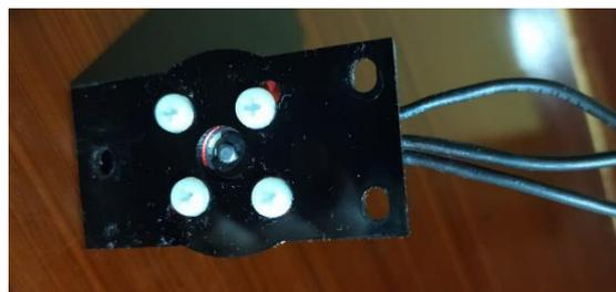
**Figura 3.39** Acople del motor a la placa de montaje de motor
