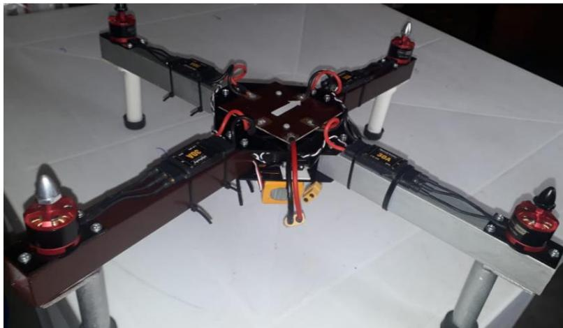
**Figura 3.43** Dron cuadricóptero implementado con todos los sistemas funcionales
