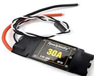
**Figura 3.8** Controlador de velocidad (ESC) [26]
