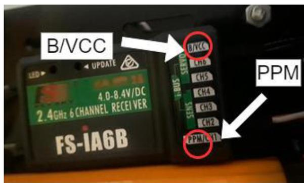
**Figura 3.17** Puerto B/VCC y PPM del receptor
