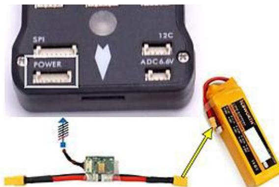
**Figura 3.28** Conexión sistema de control y sistema de alimentación
