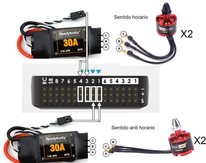
**Figura 3.29** Conexión Sistema de Propulsión al Sistema de Control
