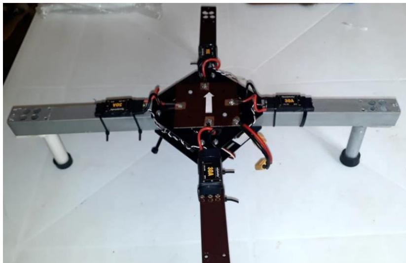
**Figura 3.38** Montaje completo de los brazos del dron
