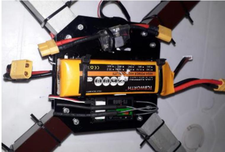
**Figura 3.42** Acople de la batería a la estructura
