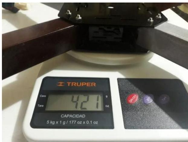
**Figura 3.44** Medición del peso total de la estructura implementada
