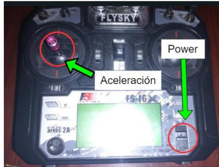
**Figura 3.22** Palanca y botón usado para la calibración de los ESCs
