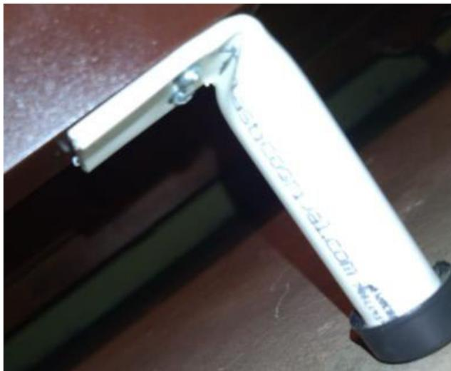
**Figura 3.13** Acople del tren de aterrizaje al brazo de la estructura.
