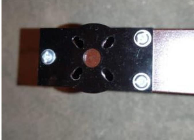
**Figura 3.12** Acople de placa de montaje de motor con brazo.
