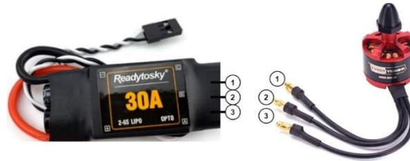
**Figura 3.24** Conexión motor CW
