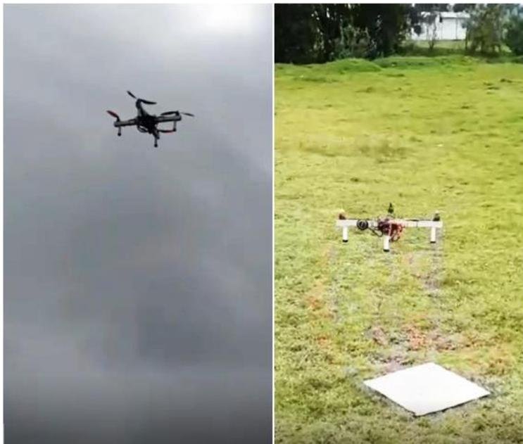
**Figura 3.45** Prueba de vuelo del dron cuadricóptero implementado
