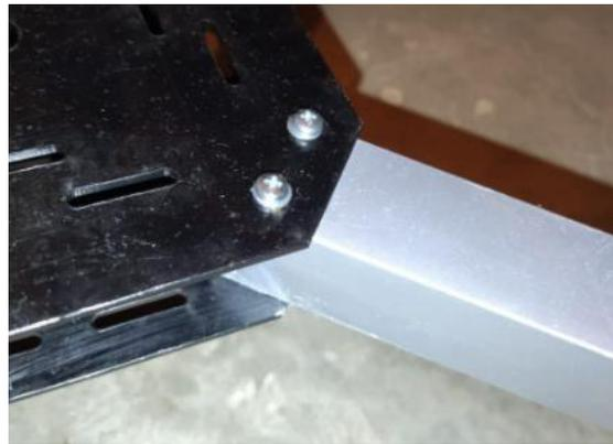
**Figura 3.11** Acople del brazo con las placas centrales.
