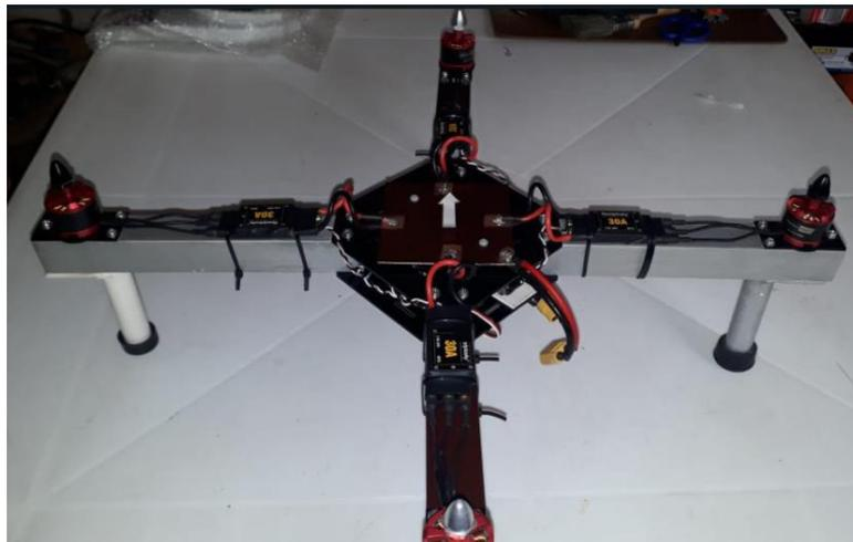
**Figura 3.41** Acople de los motores a la estructura
