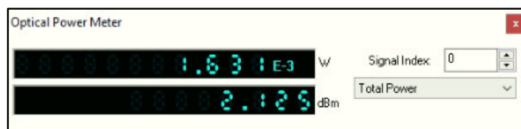
Figura 3.32 Medición realizada a la salida de los WDM transmitter 1 y 2 de la OLT
