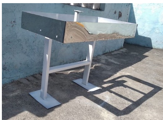
Figura 3.7 Primer armado del prototipo con fondo anticorrosivo
