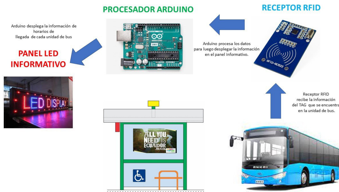
Figura 3.13 Esquema del proceso de funcionamiento del prototipo
