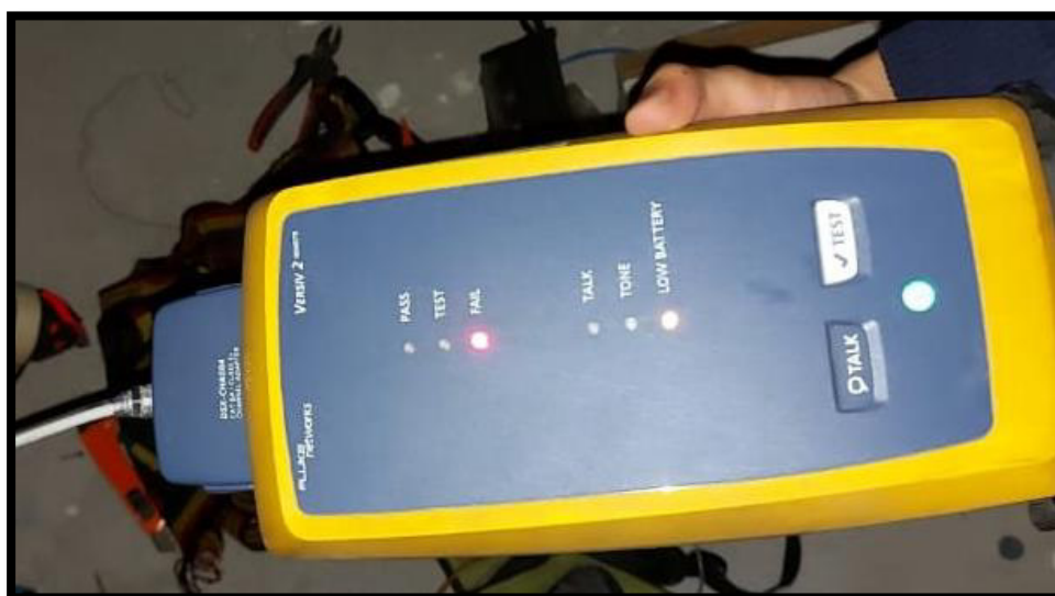
Figura 3.70 Dispositivo remoto indicando error
