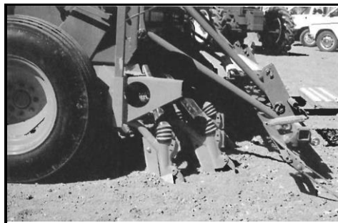
Figura 1.15 Fijación de los órganos de enterrado [10]
