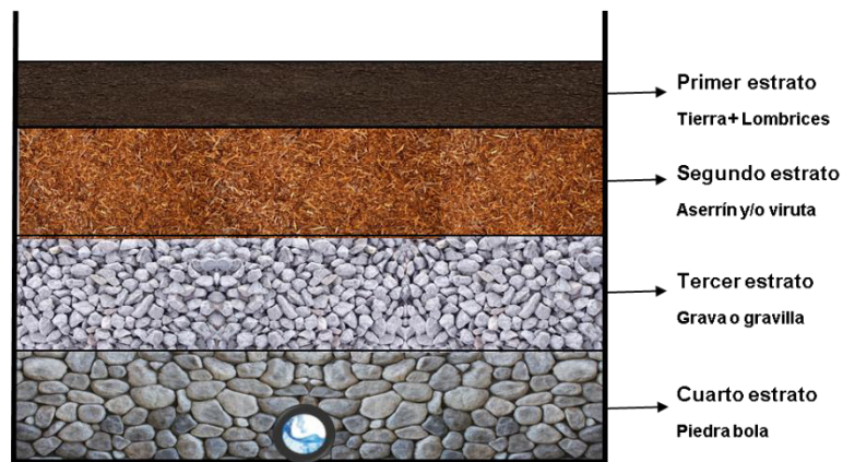
Figura 1. Estratos comunes de un lombrifiltro
