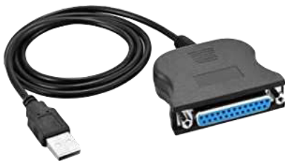
Figura 3.27 Cable adaptador USB a LPT1 [29]
