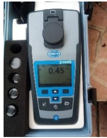
Figura 3. Medición de turbidez ( in situ ).
