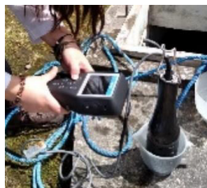
Figura 2. Mediciones in situ (temperatura, pH y oxígeno disuelto).
