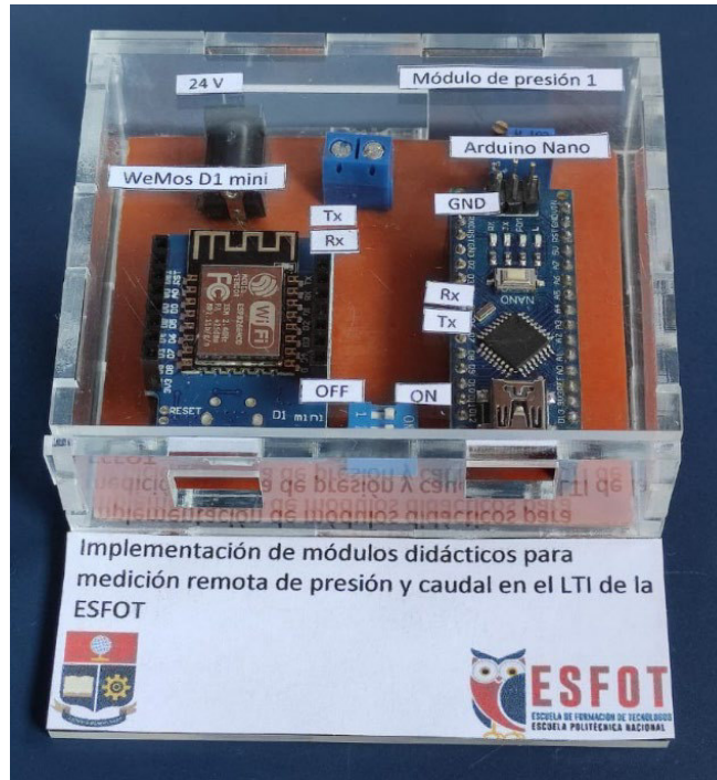
Figura 3.61 Módulo de presión etiquetado
