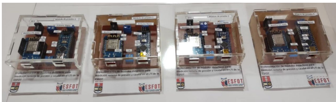
Figura 3.62 Módulos de medición remota de presión finalizados
