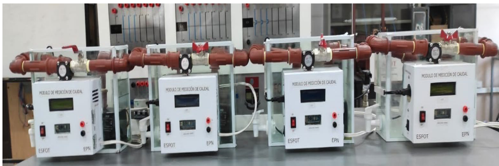
Figura 3.5 Módulos de caudal del LTI-ESFOT
