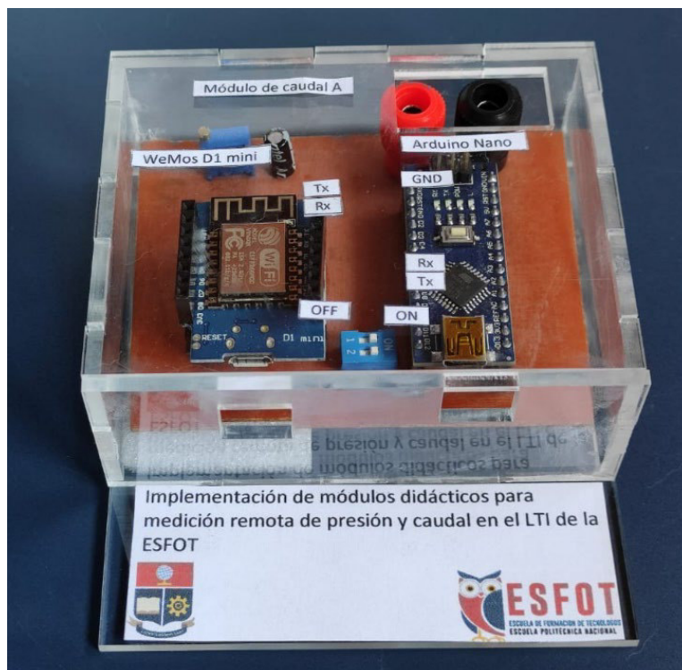
Figura 3.55 Módulo de caudal etiquetado
