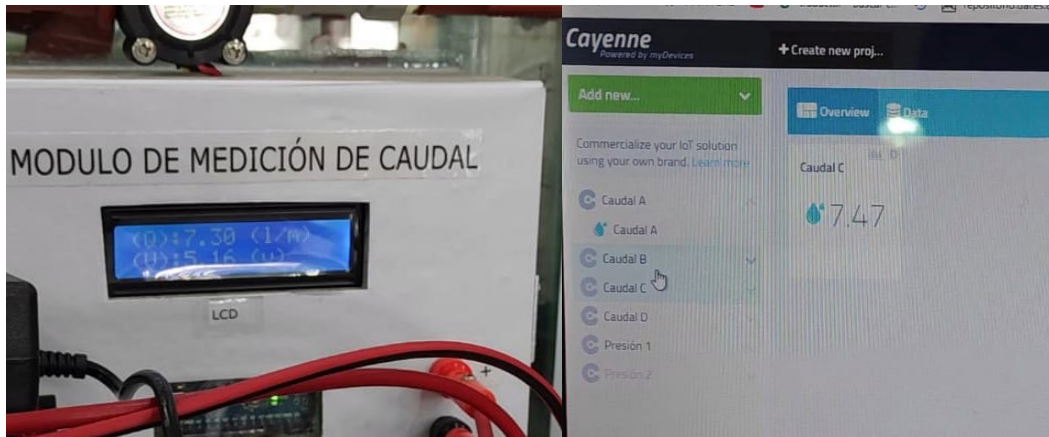
Figura 3.65 Datos del módulo de caudal C
