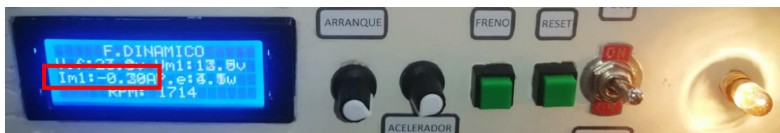
Figura 3.41 Foco conectado como carga al motor principal
