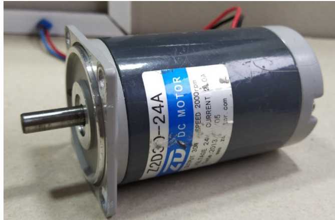
Figura 3.2 Motor principal de corriente continua
