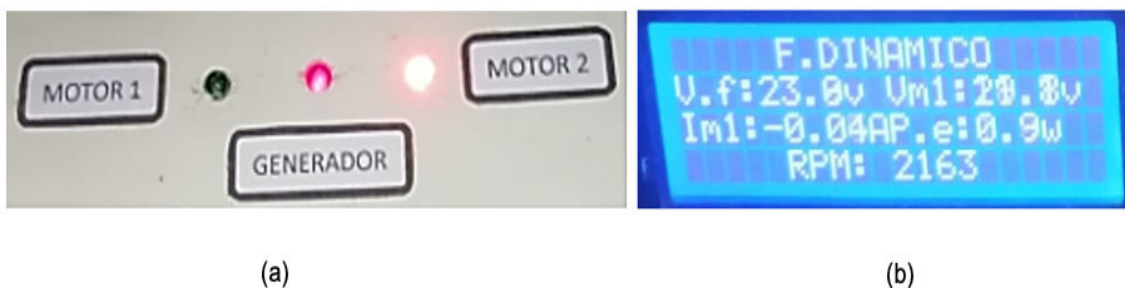
Figura 3.40 (a) Segundo y tercer led encendidos y (b) datos del freno dinámico
