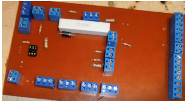
Figura 3.28 Elementos soldados en la placa
