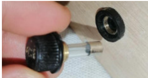
Figura 3.12 Fusible de 2 (A) y porta fusible del módulo
