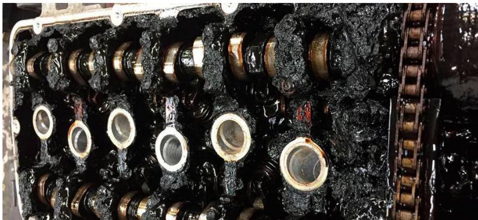
Figura 1.9 Motor con depósitos por falta de cambio de AL
