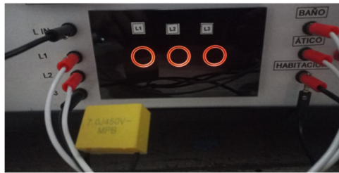
Figura 3.59 Interruptor triple encendido con su conexión
