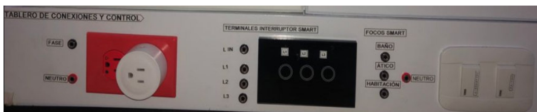
Figura 3.34 Identificación de borneras en tablero de conexiones
