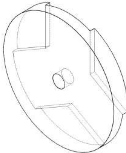
Figura 3.7 Esquema de la base de las aspas
