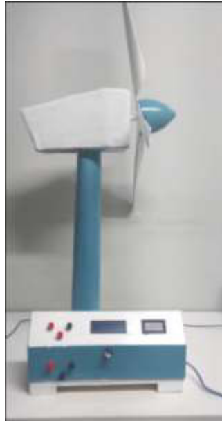
Figura 3.29 Ensamble del módulo generador
