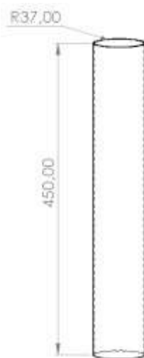
Figura 3.13 Esquema y dimensiones de la torre
