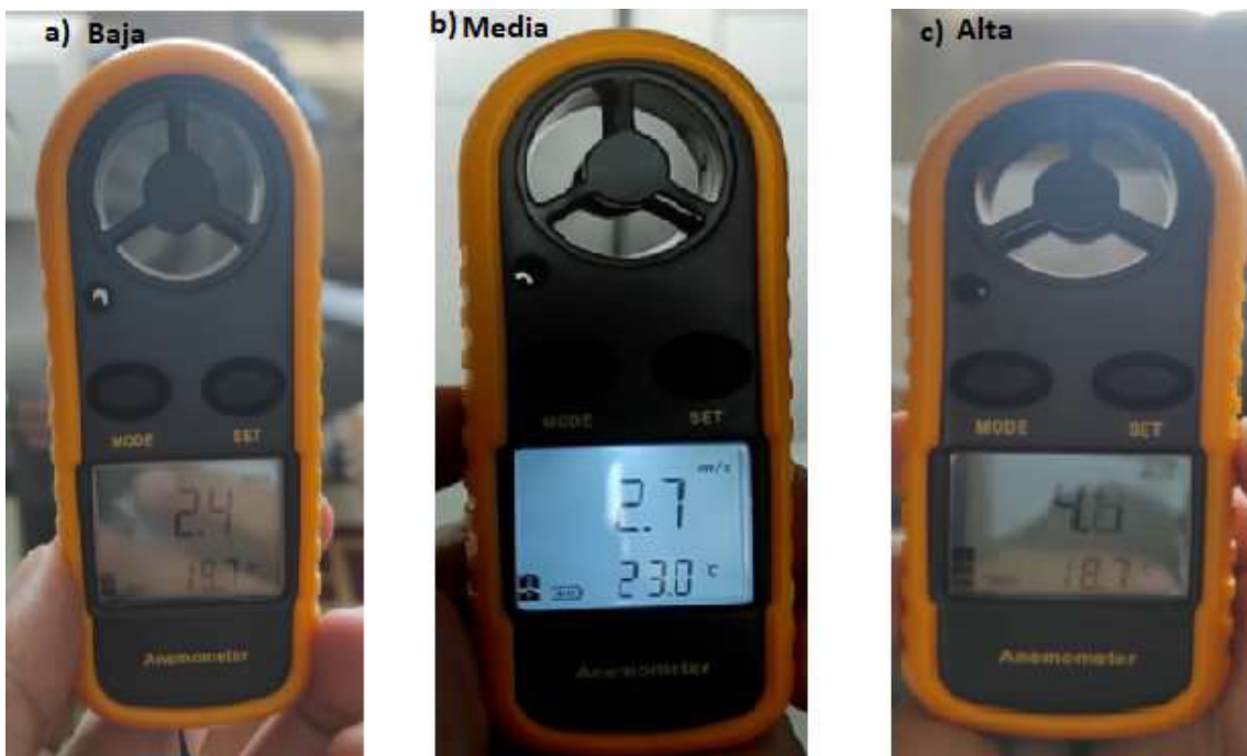
Figura 3.40 Velocidad del viento en la parte posterior del aerogenerador
