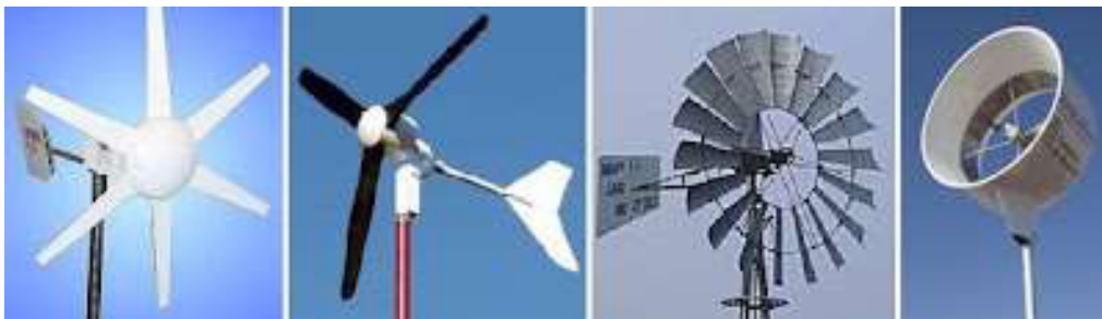
Figura 1.3 Tipos de aerogeneradores de eje horizontal [8]
