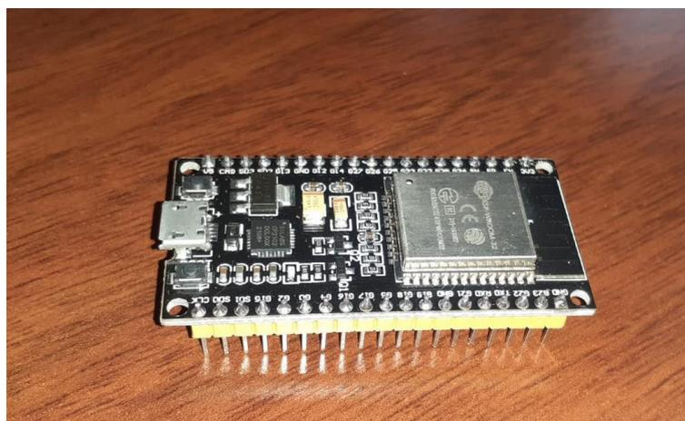
**Figura 3.6** Módulo ESP32
