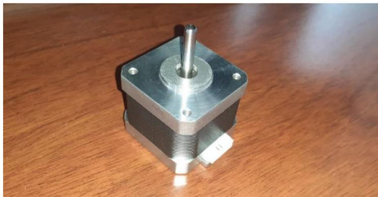
**Figura 3.5** Motor paso a paso Nema 17
