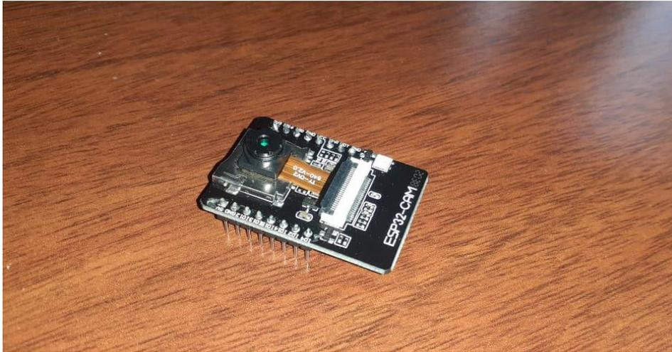
**Figura 3.11** Módulo ESP32-CAM
