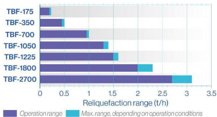
Figura 2.26. Rango de caudales admitidos por el recondensador de Air Liquide.
