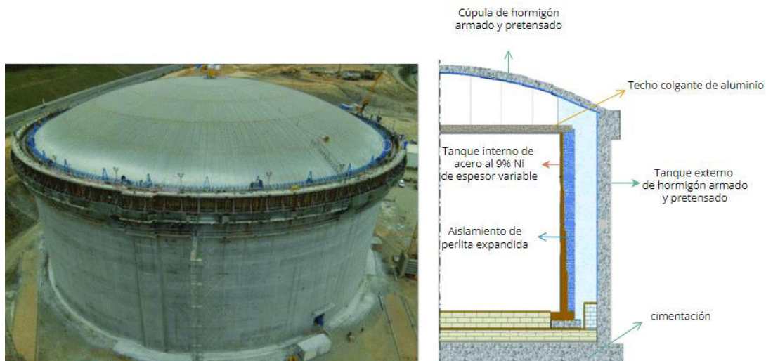
Figura 2.23. Tanque de almacenamiento vista de corte.
