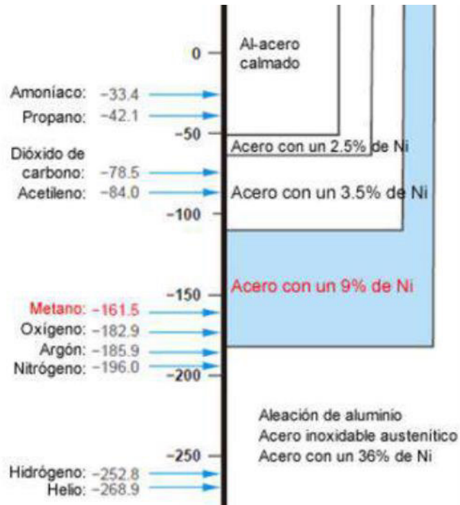
Figura 2.15. Metales para los tipos de gases.
