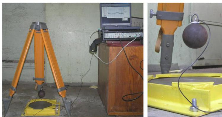
**Figura 2.20:** Ensayo experimental para obtener  $e$ .
