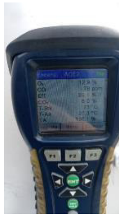
Figura 2.19. Medición de gases de chimenea. (fuente: propia)
