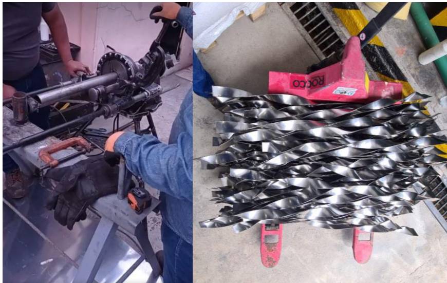
Figura 2.23. Fabricación de tubulador de cinta helicoidal retorcida. (fuente: propia)
