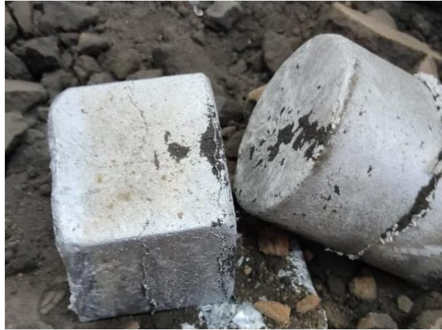
Figura 30. Tochos de aluminio al silicio obtenidos en el laboratorio. [Fuente propia]
