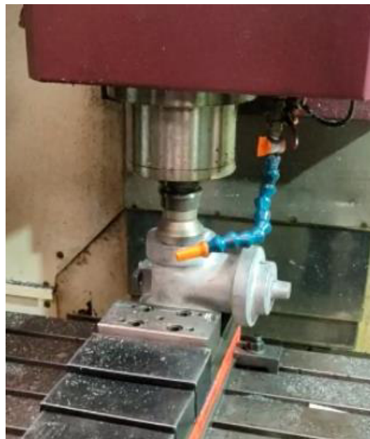
Figura 59. Planeado de las caras planas de las cámaras. [Fuente propia]
