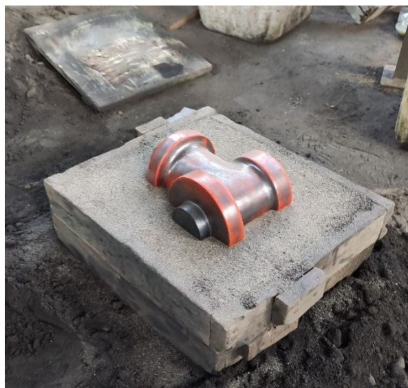
Figura 45. Caja al otro extremo con la otra sección del modelo y arena sílice. [Fuente propia]
