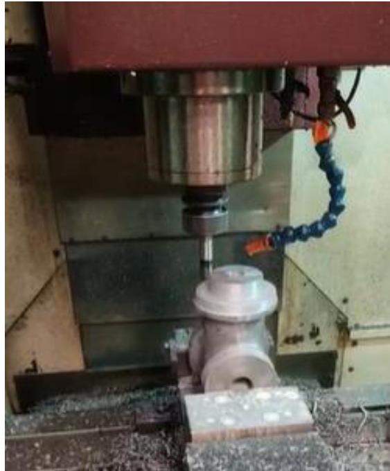
Figura 58. Cilindrado exterior de la base y acometidas de succión y descarga. [Fuente propia]
