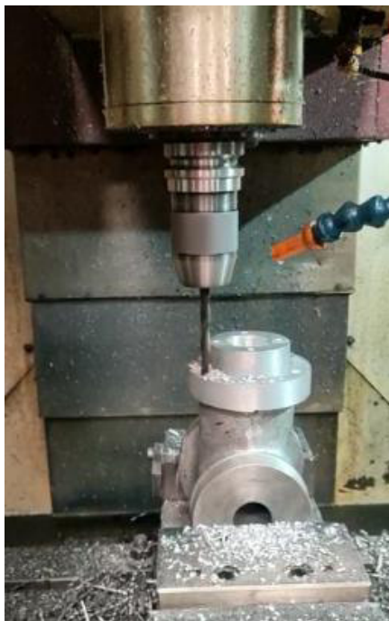
Figura 61. Perforado de las cámaras de compresión. [Fuente propia]
