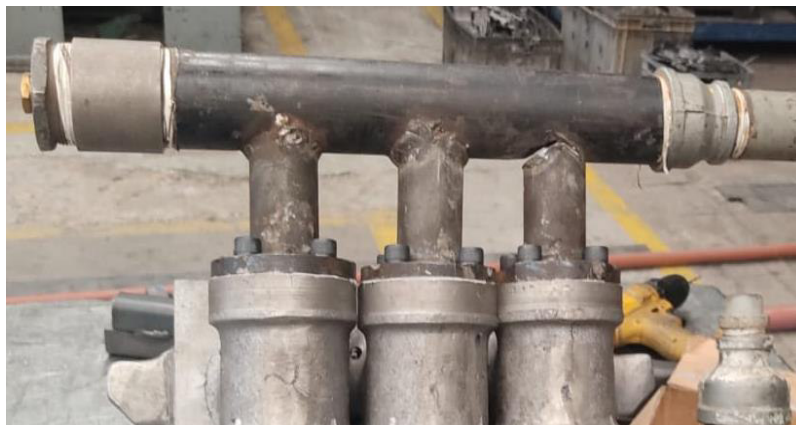
Figura 65. Tubería de descarga desoldada. [Fuente Propia]
