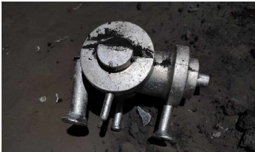
Figura 55. Cámara de compresión fundida. [Fuente propia]
