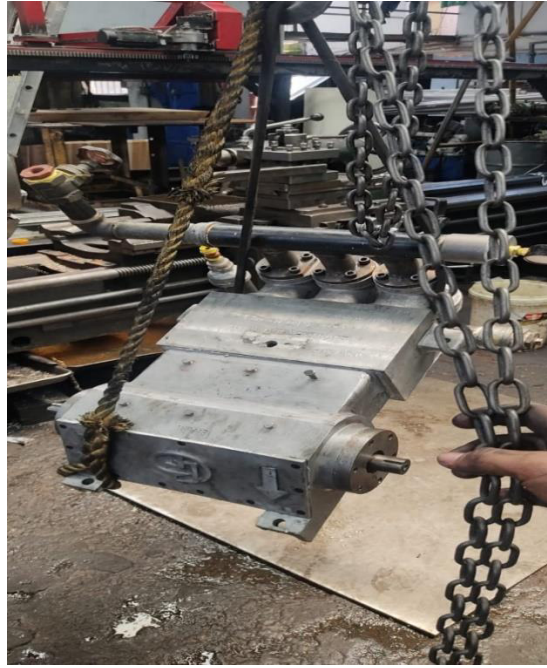
Figura 74. Montaje de la bomba en el torno con ayuda de un tecla. [Fuente Propia]
