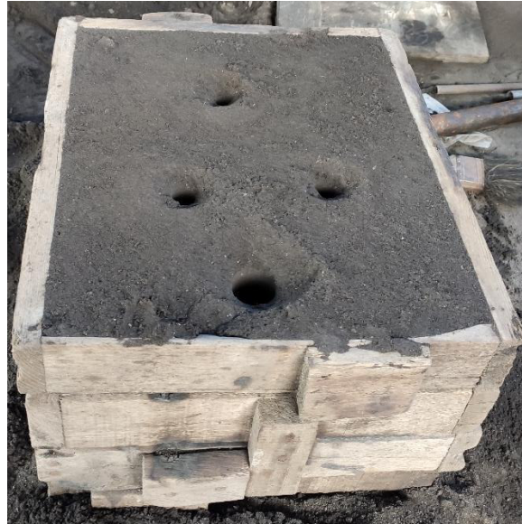
Figura 46. Molde completo y sin exceso de arena en la caja macho. [Fuente propia]
