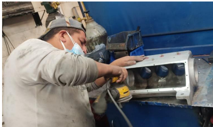
Figura 70. Limpieza superficial utilizando pulidora. [Fuente propia]
