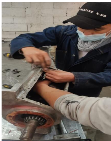
Figura 66. Desmontaje del block de la bomba. [Fuente propia]
