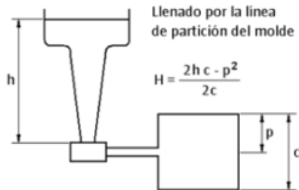
Figura 3. Salto efectivo según la forma de llenado del molde [1].
