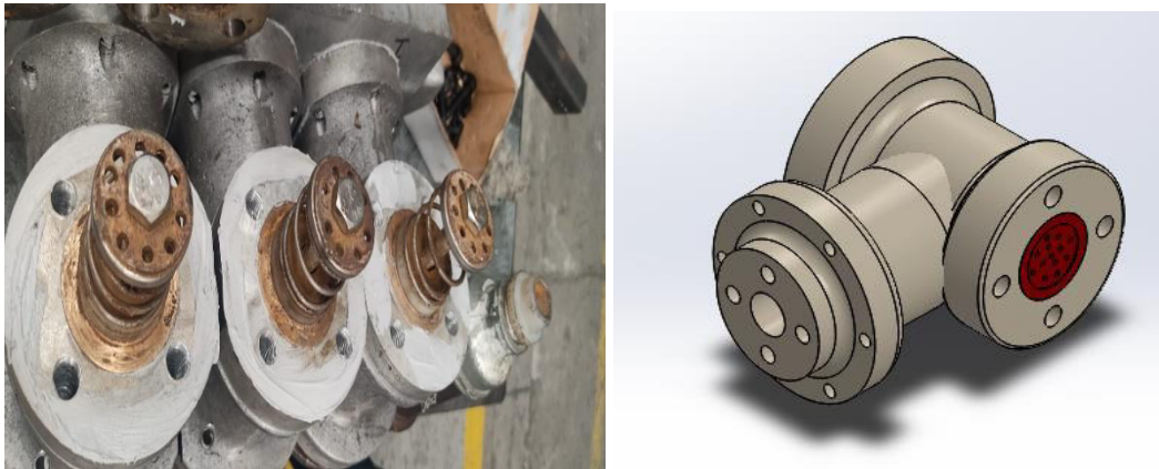
Figura 32. a) Válvulas de descarga ancladas a la superficie de la Cámara, b) Cámara en 3D con el nuevo diseño. [Fuente propia]
