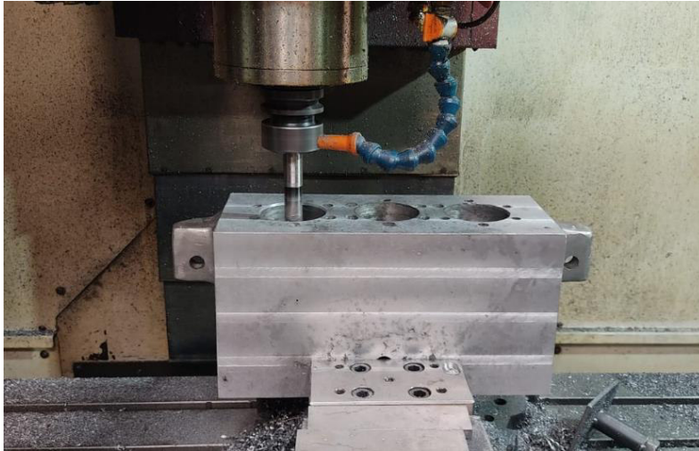
Figura 72. Rectificación de las perforaciones que se unen con el block. [Fuente Propia]
