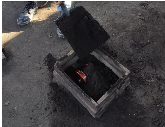
Figura 43. Relleno de la caja de moldeo. [Fuente propia]
