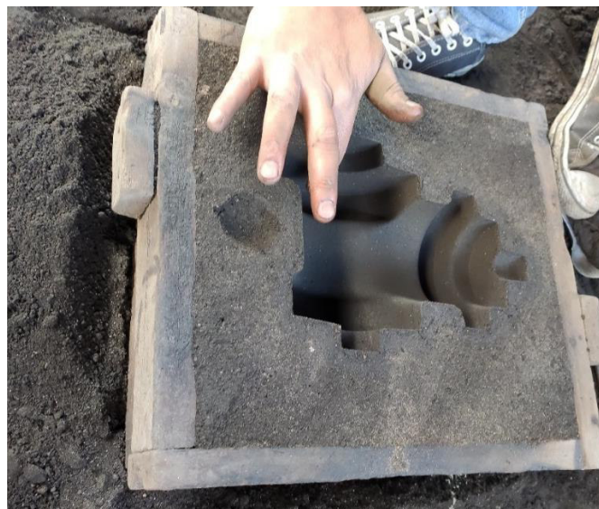
Figura 47. Limpieza del molde, luego de extraer el modelo. [Fuente propia]
