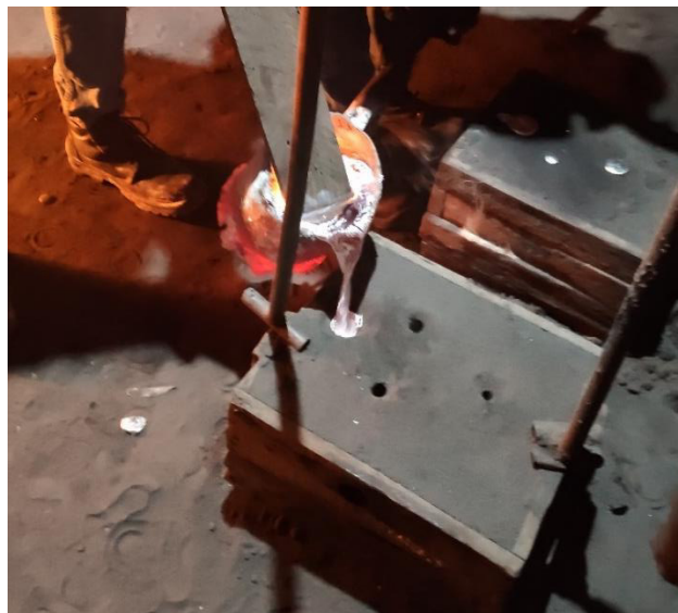
Figura 52. Colado del material en los moldes de arena. [Fuente propia]
