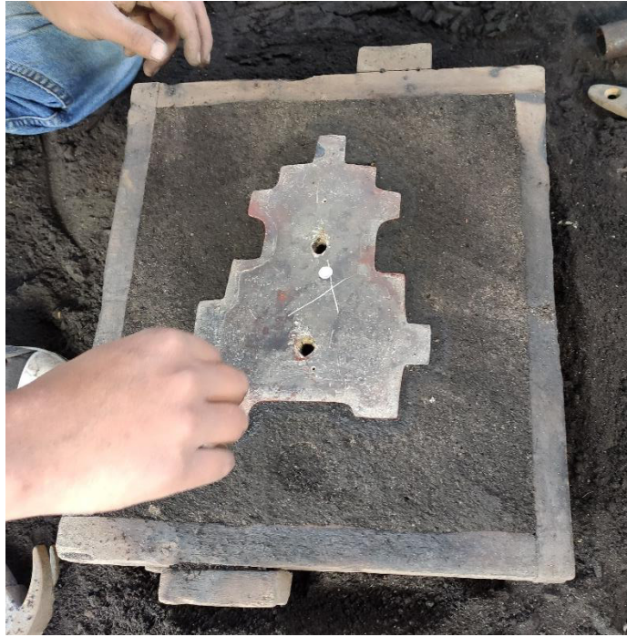
Figura 44. Arena de moldeo al nivel de la caja. [Fuente propia]
