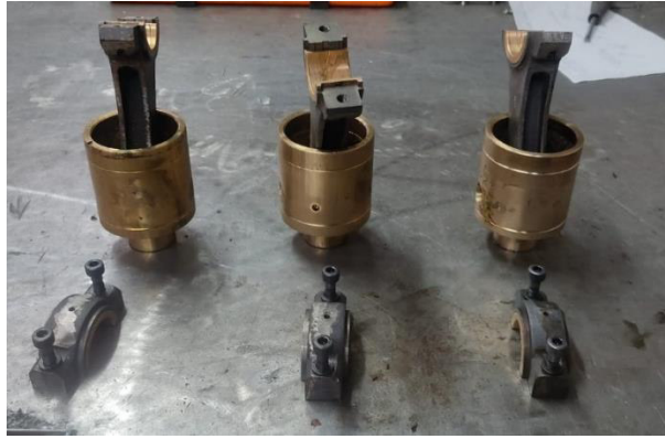
Figura 69. Pistones desarmados y limpios. [Fuente propia]
