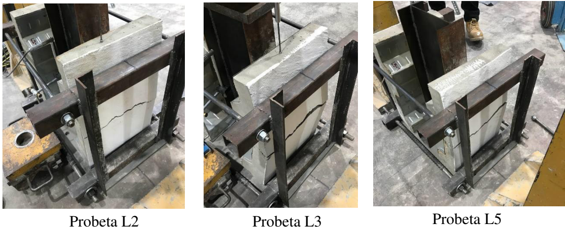
Figura 68. Modo de falla – Probetas tipo L
