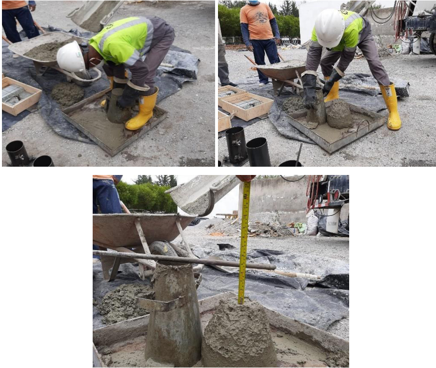
Figura 49. Proceso de elaboración Ensayo de Asentamiento
