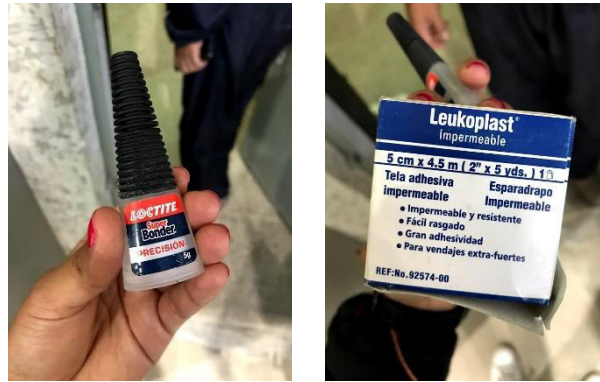
Figura 39. Materiales utilizados para la pega de strain gauges
