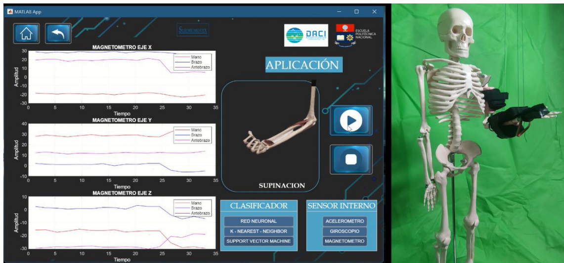
Figura 3.6 Detección de la posición de supinación utilizando el clasificador de Máquina de Soporte Vectorial, con datos del magnetómetro.
