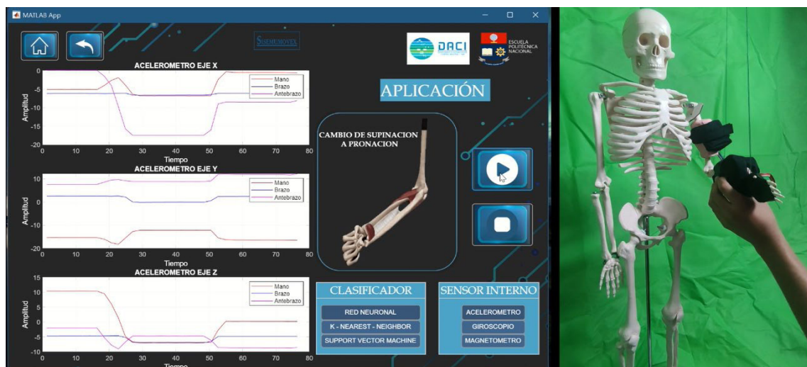
Figura 3.29 Detección del movimiento de cambio de supinación a pronación utilizando el clasificador de Redes Neuronales Amplia, con datos del acelerómetro.
