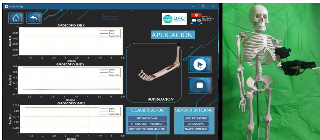
Figura 3.17 Detección de la posición de supinación utilizando el clasificador de K-vecinos más cercanos - coseno, con datos del giroscopio.
