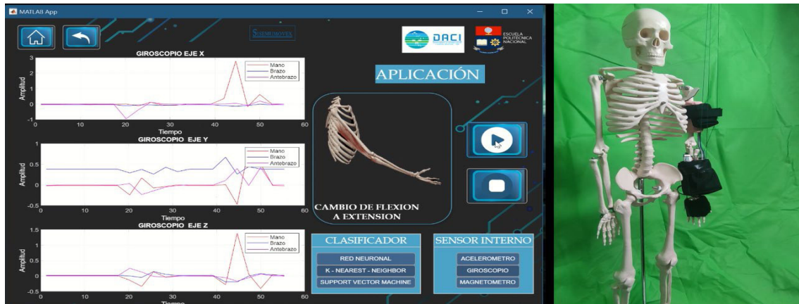
Figura 3.19 Detección del movimiento de cambio de flexión a extensión utilizando el clasificador de K-vecinos más cercanos - coseno, con datos del giroscopio.
