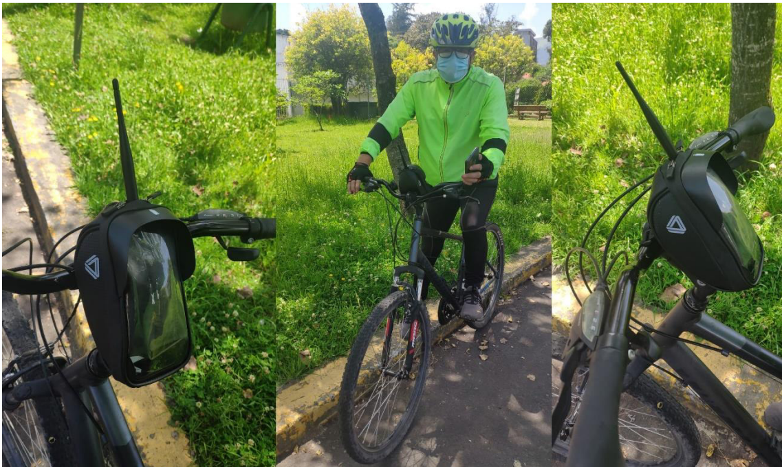
Figura 2.45 Nodo Sigfox colocado en la bicicleta.
