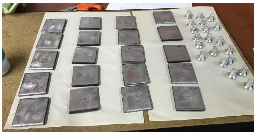
Figura 16. Probetas y sufrideras utilizadas en el ensayo de pull off.
