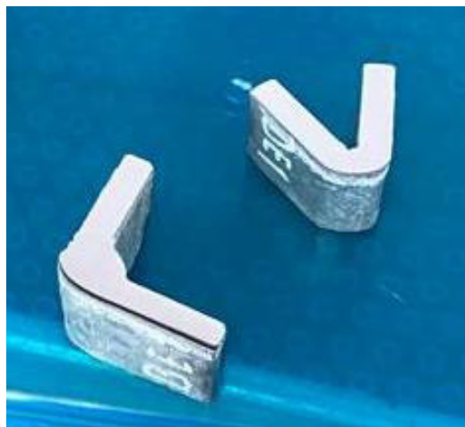
Figura 12. Probetas para ensayo de enfriamiento brusco.
