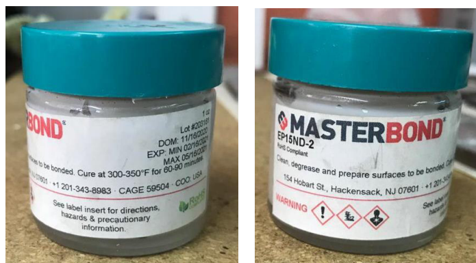
Figura 15. Pasta adhesiva utilizada para el ensayo de Pull-Off.
