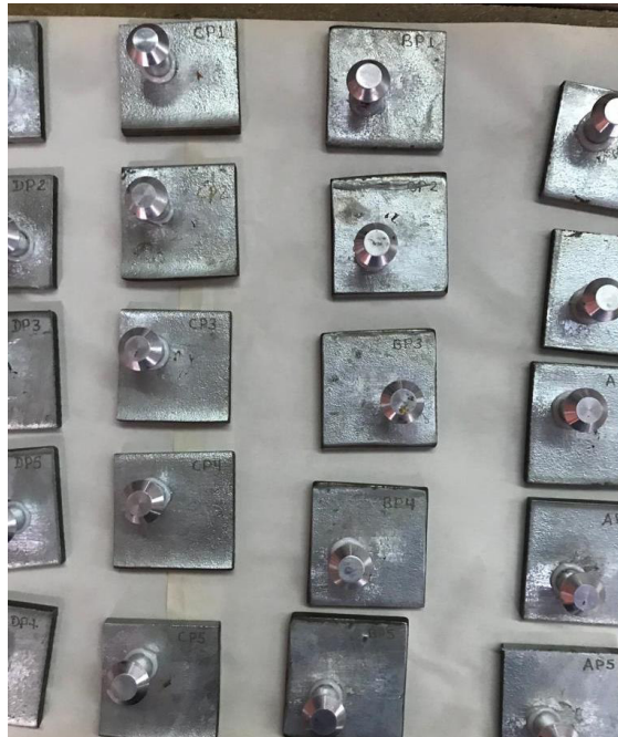
Figura 17. Conjunto Probeta-Pasta Adhesiva-Sufridera. Fuente: Propia
