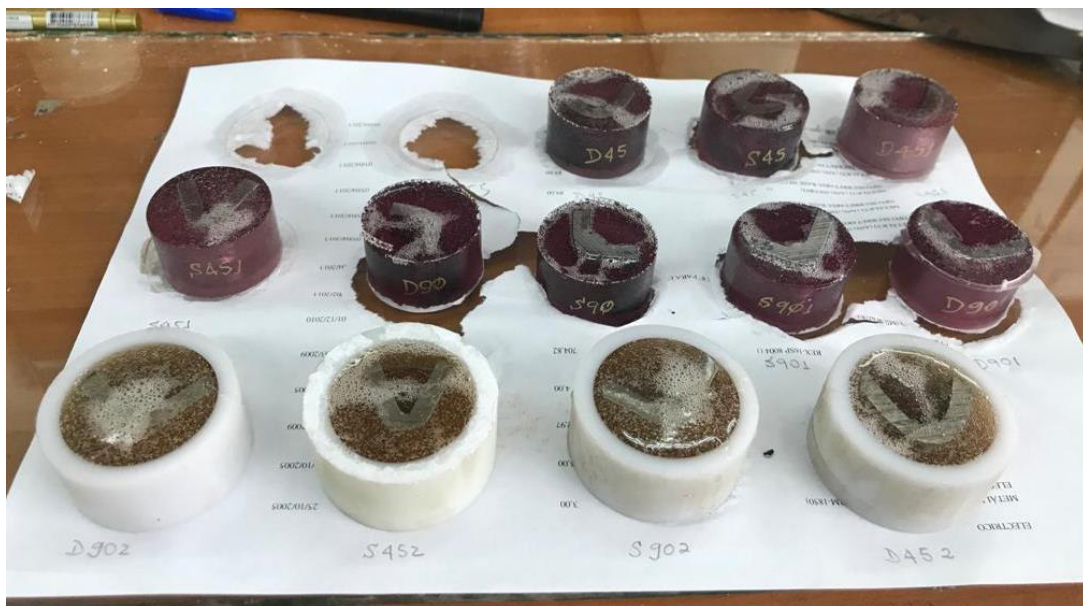
Figura 20. Montaje de probetas para desbaste fino y pulido previo al análisis metalográfico.
