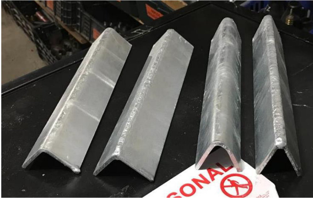
Figura 11. Perfiles Angulares Galvanizados por Inmersión en Caliente. Fuente: Propia
