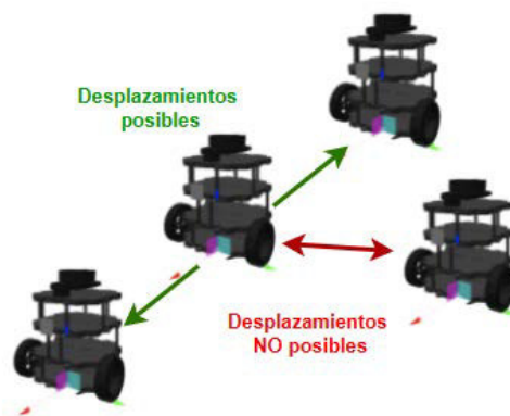
Figura 1.2 Representación de restricción no-holonómica de robots móviles de tracción diferencial [Fuente propia]
