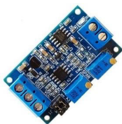
Figura 2.8. Módulo conversor de corriente a voltaje [39]
