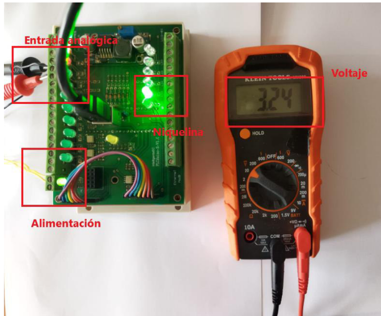
Figura 3.21 Prueba de funcionamiento a baja temperatura
