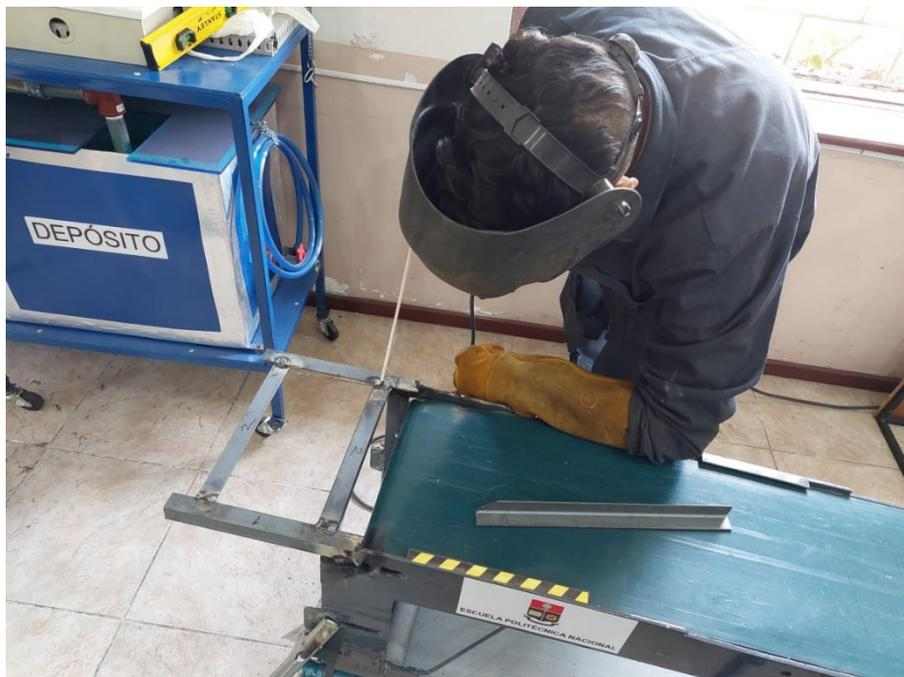
Figura 3.39: Proceso de soldadura tipo Smaw
