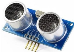
**Figura 3.11:** Sensor de ultrasonido [11]
