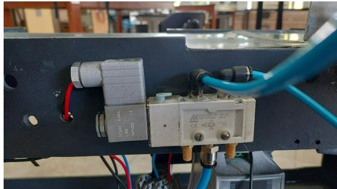
**Figura 3.50:** Conexión de las electroválvulas
