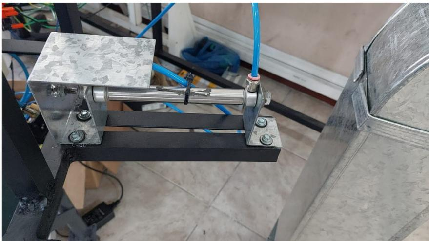
**Figura 3.42:** Estructura cilindro neumático pequeño
