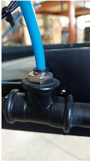
**Figura 3.54:** Racor con rosca de 1/4 (in) y salida de manguera #8
