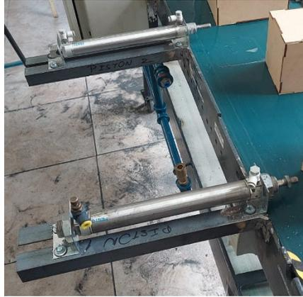
**Figura 3.8:** Cilindros neumáticos reubicados
