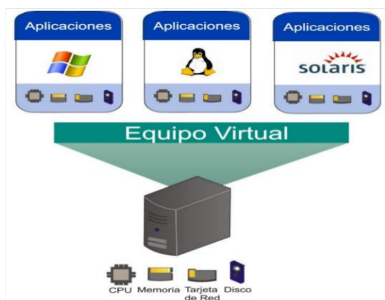
Figura 1.11. Virtualización del Hardware, Máquina Virtual [28].
