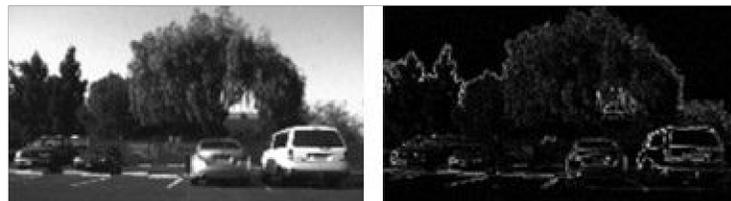
**Figura 1.10** Algoritmo Sobel de detección de contornos
