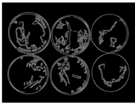
**Figura 1.13** Algoritmo Canny de detección de contornos
