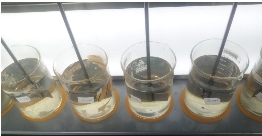
FIGURA 3.14. Ensayo de prueba de jarras con sulfato de aluminio.
