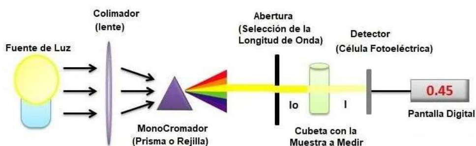
Figura 3. Componentes del espectrofotómetro.
