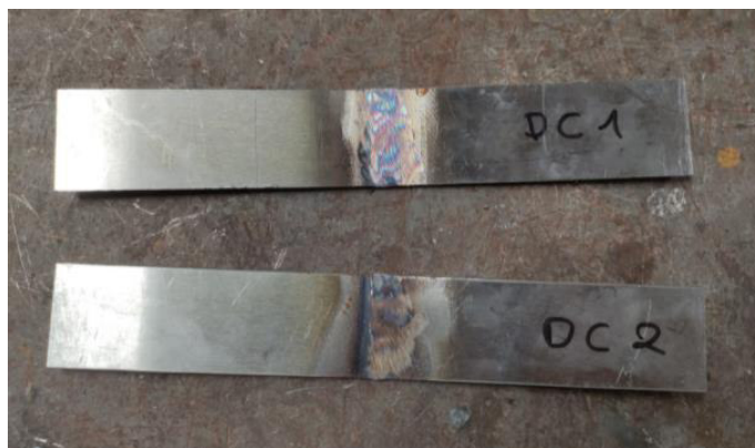
Figura 2.20 Probetas normalizadas para el ensayo doblado de cara.
