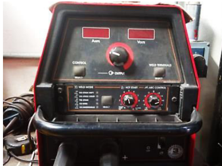
Figura 2.3 Equipo de soldadura GTAW utilizado para soldar las probetas.
