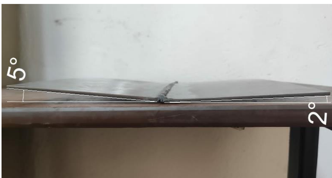
Figura 2.8 Deformación angular probeta N°2.
