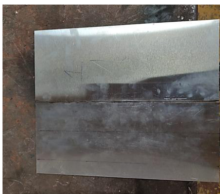
Figura 2.1 Probeta punteada antes de la soldadura.
