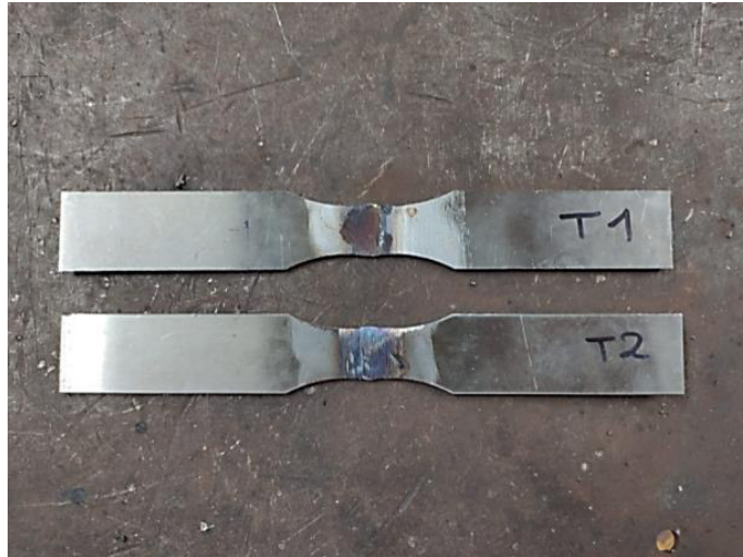
Figura 2.13 Probetas normalizadas T1 y T2 mecanizadas para ensayo de tracción.
