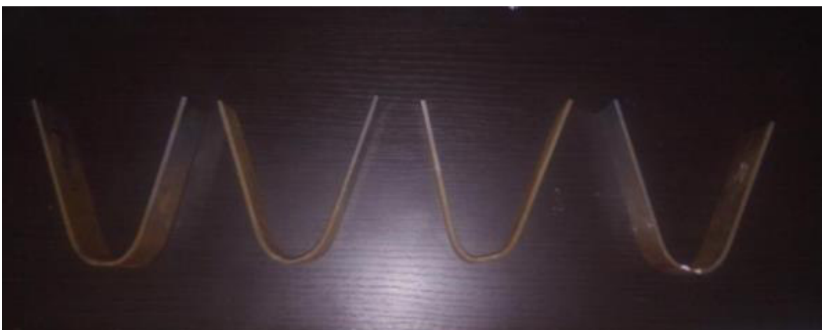
Figura 2.21 Probetas normalizadas sometidas a doblado de cara y raíz.
