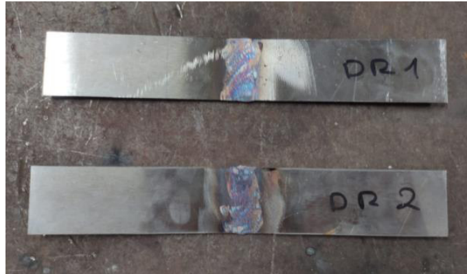
Figura 2.19 Probetas normalizadas para el ensayo de doblado de raíz.
