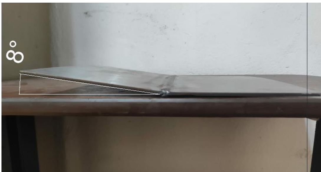
Figura 2.7 Deformación angular probeta N°1.
