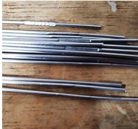
Figura 2.2 Varillas de aporte ER-308L de 3/32 pulgadas de diámetro.
