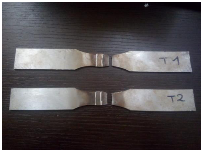
Figura 2.14 Probetas normalizadas T1 y T2 al final del ensayo de tracción.
