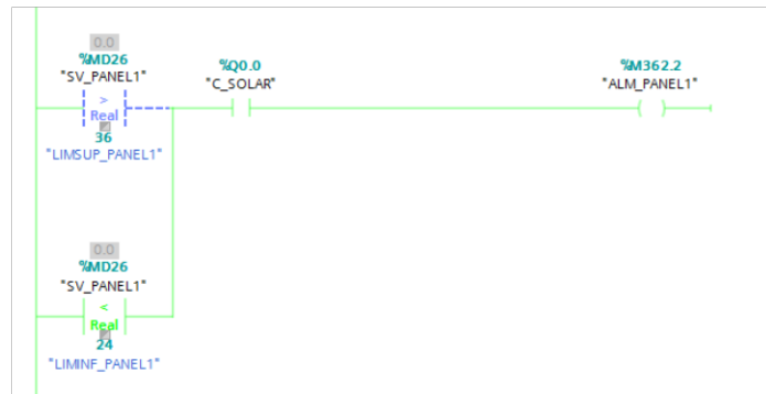
Figura 3.13. Alarma activada debido a que el voltaje del panel 1 está fuera de rango.
