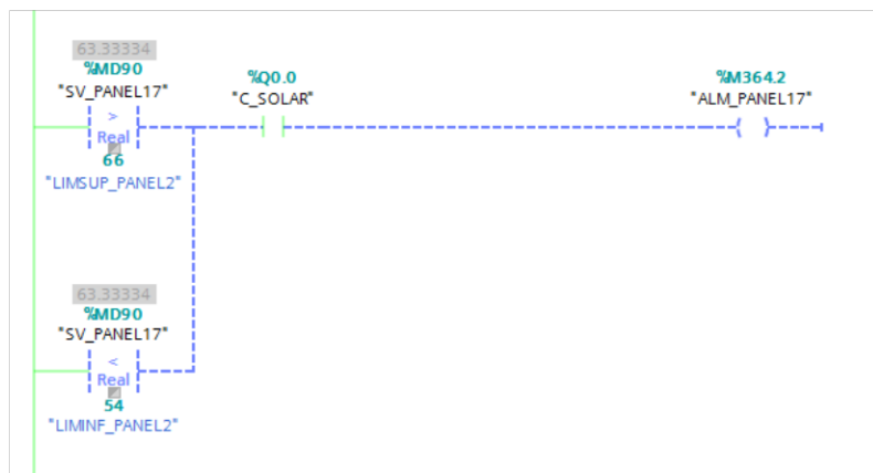
Figura 3.19. Alarma desactivada debido a que el voltaje del panel 17 está dentro del rango establecido.
