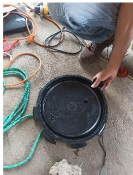
Imagen 13. Perforaciones en la tapa del biodigestor
