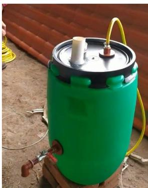
Imagen 20. Biodigestor con manguera de gas
