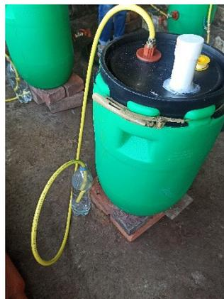
Imagen 31. Biodigestor para biol completo
