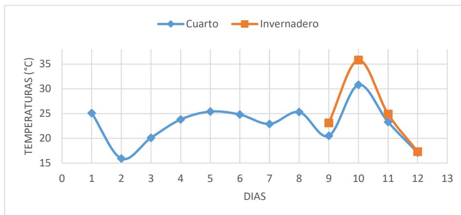
Grafico 1. Temperaturas externas biodigestores
