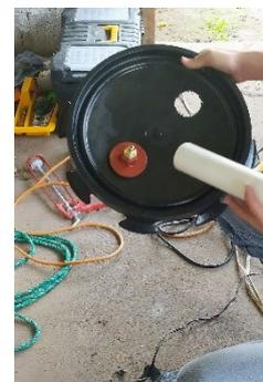
Imagen 14. Colocación tubo PVC en la tapa
