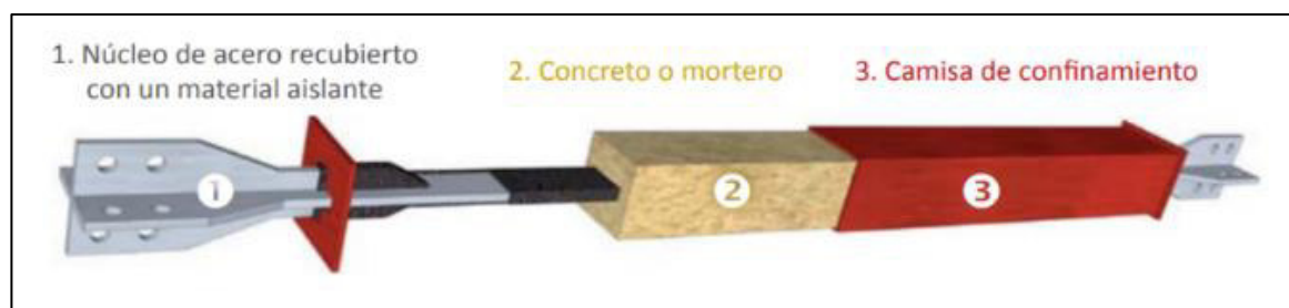
Figura 2.5. Composición de un BRB.
