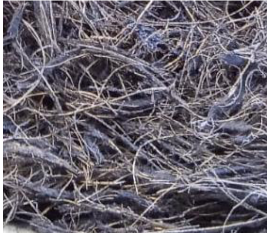
Figura 14. Fibras con el tratamiento de humo de sílice
