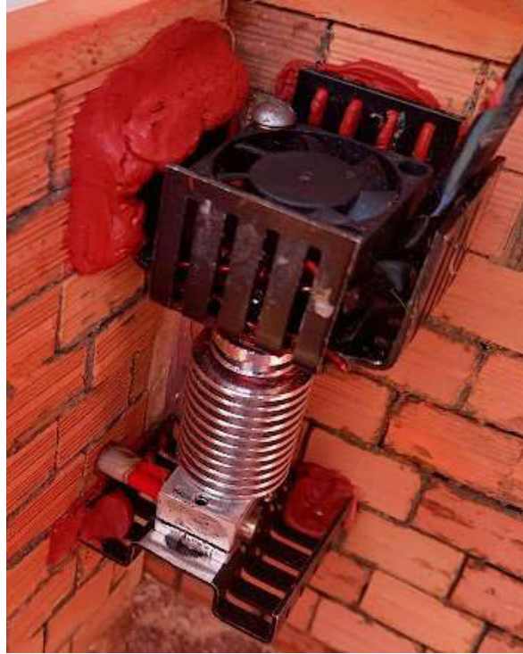
Figura 3-5 Niquelina y disipador de calor del extrusor
