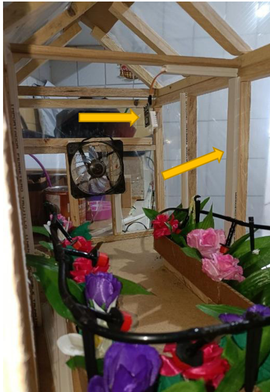
Figura 3.53 Instalación del sensor de temperatura DHT22la
