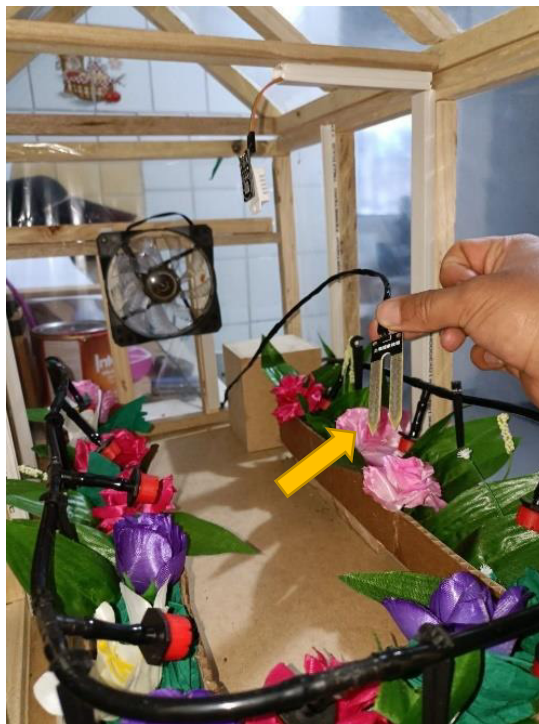
Figura 3.52 Sensor de humedad FC-28 implementado
