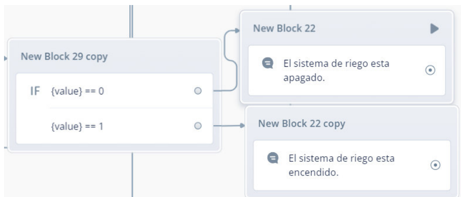
Figura 3.23 Configuración de los bloques para que Alexa mencione el estado del sistema de riego
