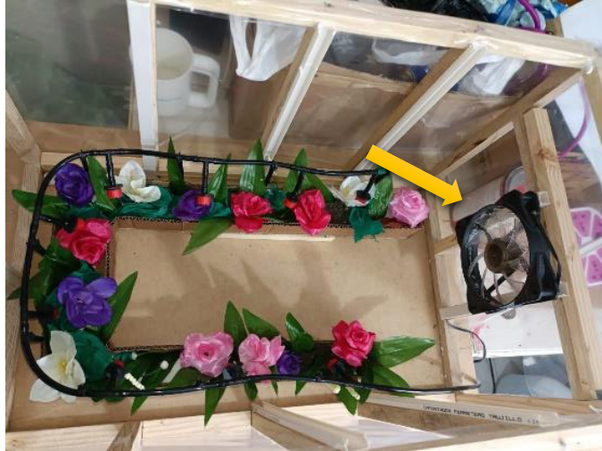
Figura 3.51 Sistema de ventilación implementado
