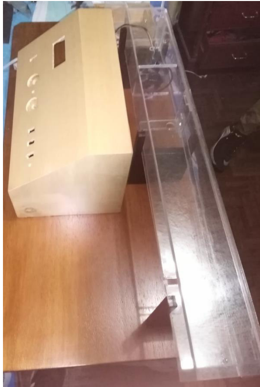
Figura 3.4 Ensamblaje de estructura de madera, tablero de control y ducto.
