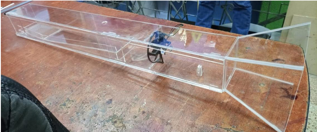
Figura 3.1 Ensamblaje de embudo y ducto.
