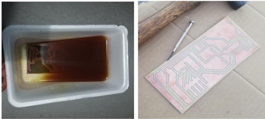
Figura 3.10 Proceso y resultado de la utilización del ácido férrico
