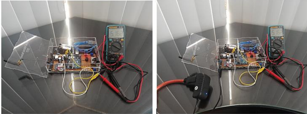
Figura 3.23 Comprobación de funcionamiento con batería y cargador
