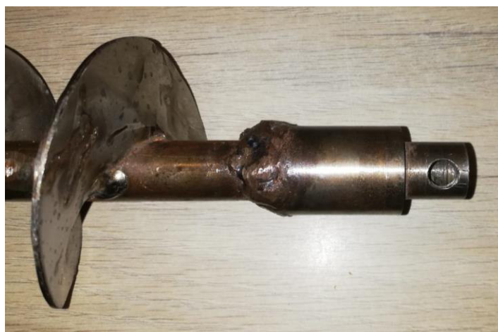
Figura 2.13 Acople del eje del motor con tornillo sin fin.
