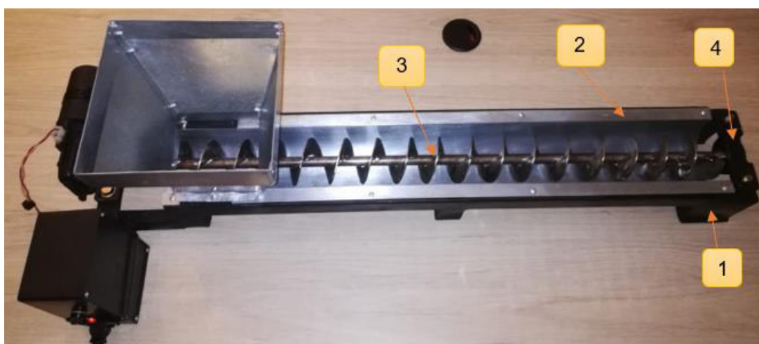
Figura 3.1 Módulo didáctico de automatización de comedero de pollos
