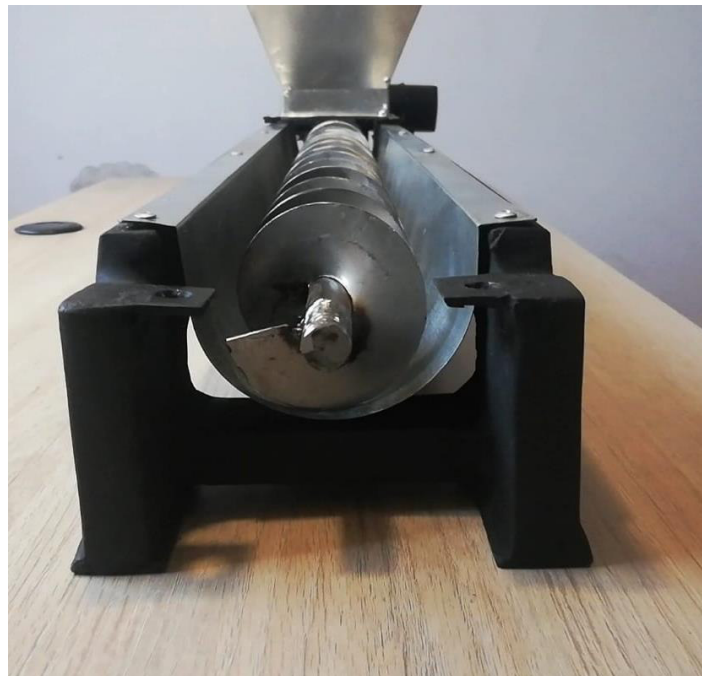
Figura 3.6 mínima fricción entre tornillo sin fin y carcasa en u.
