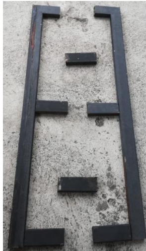
Figura 2.7 Metal base para la estructura.
