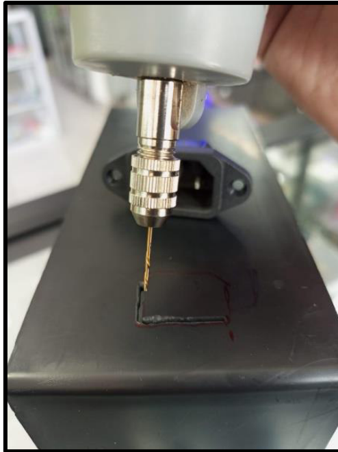
Figura 2.4 Perforación para el conector de alimentación AC
