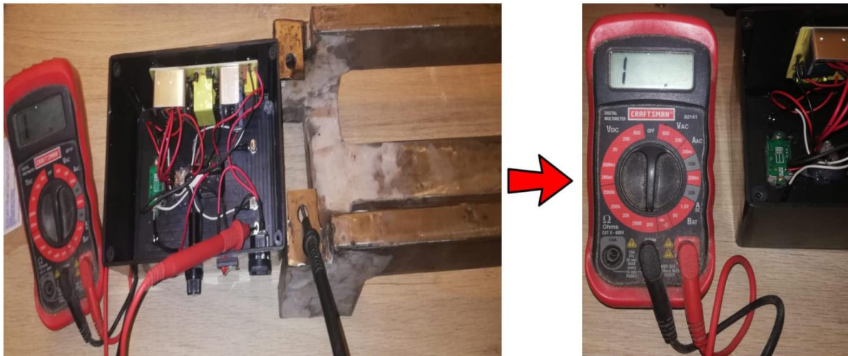
Figura 3.6 Prueba de continuidad y cortocircuito
