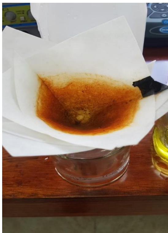
Figura 6.9. Filtrado del agua residual tratada
