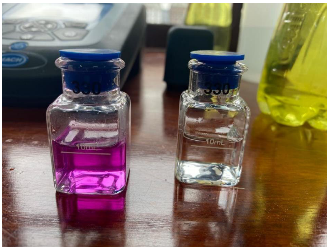
Figura 6.6. Determinación de cromo hexavalente
