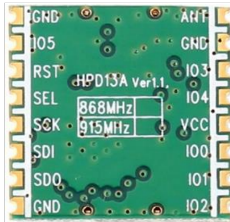
Diagrama de Pines del Transceptor SX1276 modelo HPD13A V1.1
