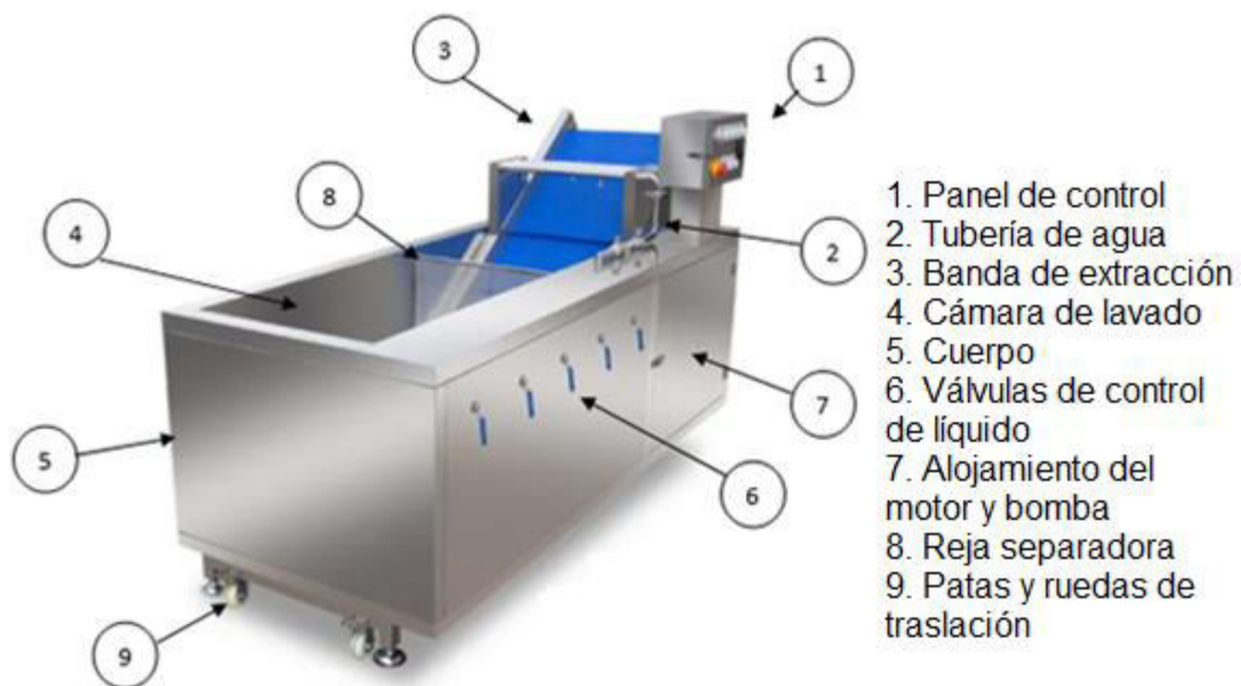
Figura 1.7 Lavadora hidrodinámica de hortalizas. Fuente: (Teng, 2012)
