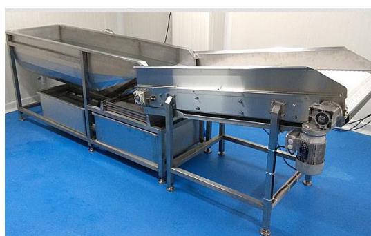
Figura 1.9 Lavadora de hortalizas por turbulencia HIDACAM.
