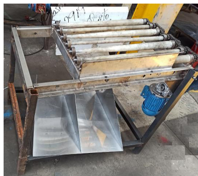
Figura 2.53 Montaje de las bandejas de selección de papas Fuente: (Propia)
