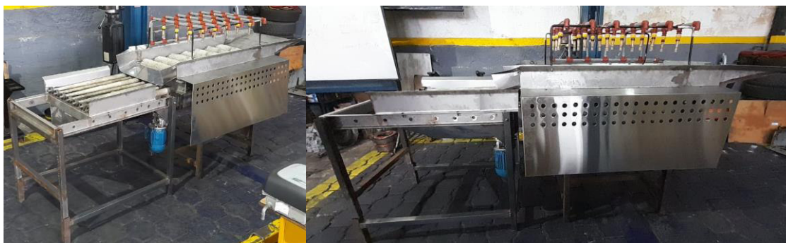
Figura 2.54 Montaje de las bandejas de selección de papas Fuente: (Propia)
