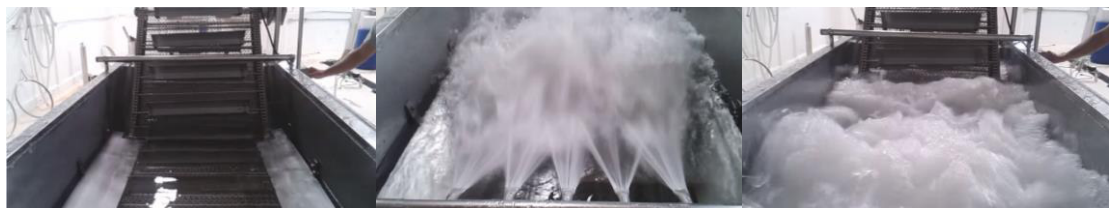
Figura 1.6 Puesta en acción de la lavadora hidrodinámica de hortalizas. Fuente: (Solis, 2015)
