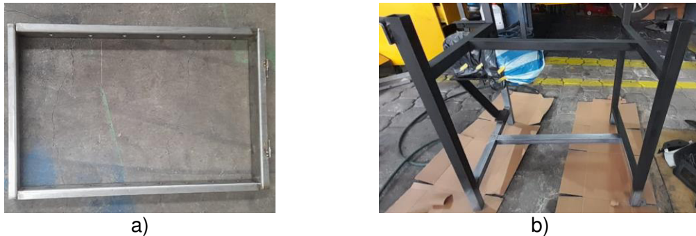
Figura 2.40 Estructura a) de soporte, b) bastidor Fuente: (Propia)
