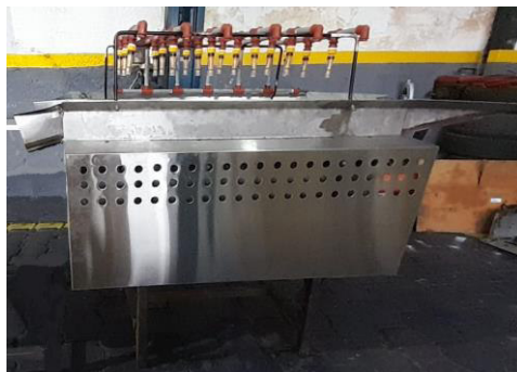
Figura 2.51 Montaje del sistema de lavado Fuente: (Propia)
