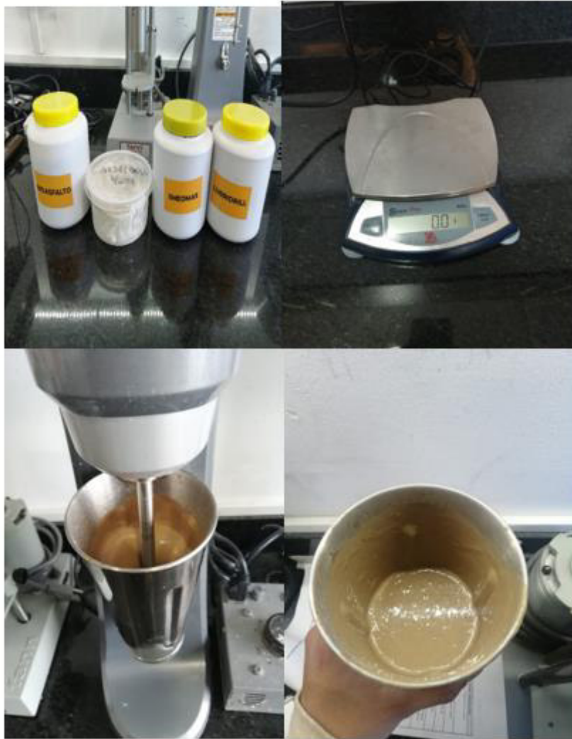
Figura 11 Procedimiento para la preparación del lodo de perforación
